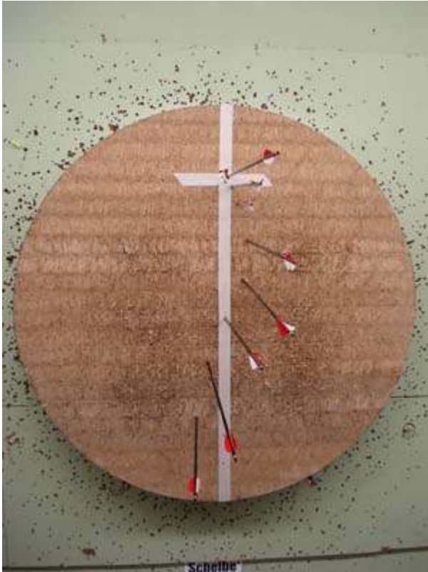
Bild 5: Button-Druck zu groß UND Button-Abstand zu gering. Der Bauch wird von einer linearen Auslenkung überlagert.
